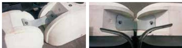
取付は、六角ボルトM16ネジ切50mmを基本にします。強度区分4.8以上のものを使用して下さい。なお、プレートの上下に平座金を用います。
