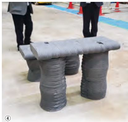
写真④⑤ 著者らの研究グループで作製したベンチ(3DCPを使用し、 積層体内部に補強材が導入されている)
